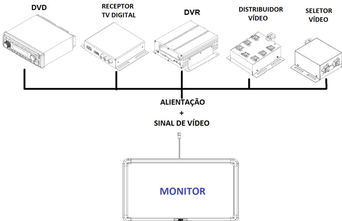
Figura 1.2 – Esquema de Ligação do Monitor 23”
