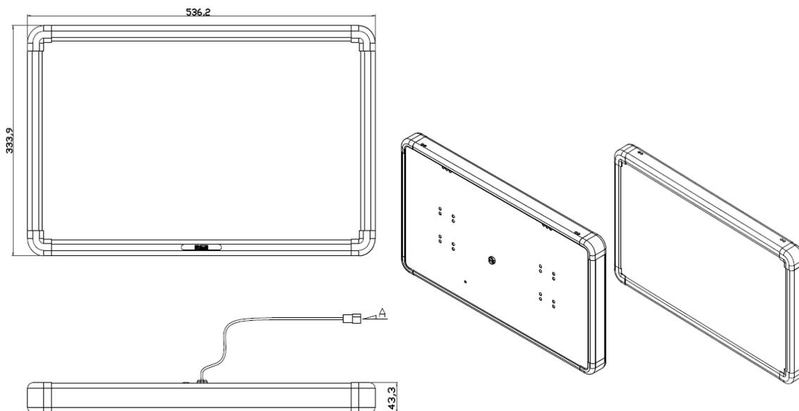
Figura 1.0 – Dimensões do Monitor 23”
