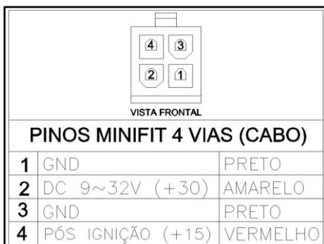
Figura 1.3 – Pin-Out Conector de Alimentação
